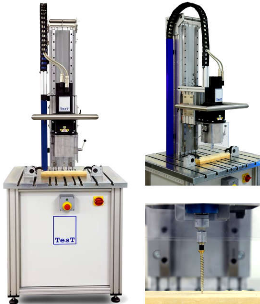
220系列立式扭转试验机+恒力系统
