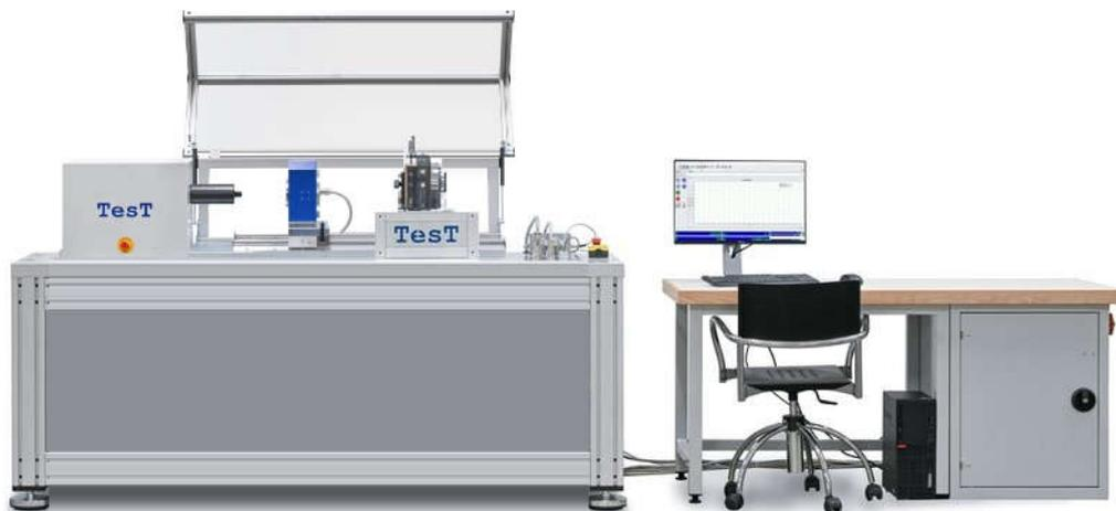
综合测试方案 (紧固性能、防松性能“一站式”测量)
